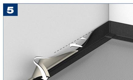
Estender SILENS GP 1 em todos os pontos em elevação da superfície de modo a realizar a total dessolidarização da posterior betonilha em relação ao resto da estrutura. Em todos os pontos em que for necessário cortar SILENS GP 1, para poder criar a angulação correta, deve-se restabelecer a continuidade do isolante com a fita SILENS NA 1.
