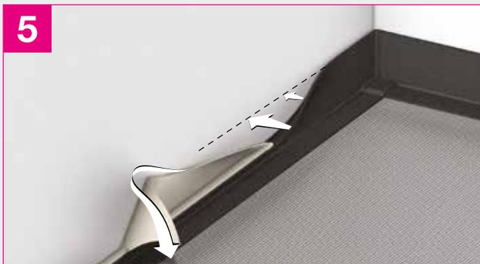
Retirar também a outra fita adesiva, a do lado mais longo, e colar à parede. É muito importante tratar dos cantos e arestas; a cola tem de aderir perfeitamente à parede, de modo a facilitar a aplicação subsequente do revestimento.
