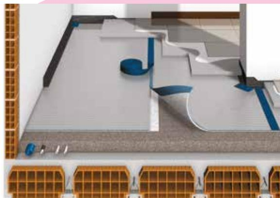
Isolante acústico em telas para ruídos de impacto. SILENS STA 10 é uma tela produzida através da combinação de polietileno expandido reticulado quimicamente de células fechadas acoplado a tecido não tecido em fibra de poliéster.
