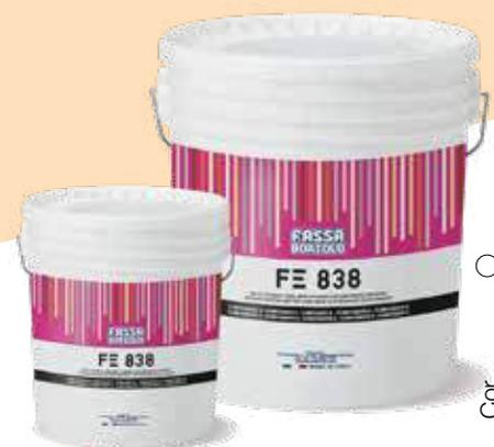
Cola e betume epóxi, bi-componente, antiácido para juntas de 3-15 mm, para interior e exterior. Ótimo também como cola. Ideal nos casos que requerem um grau elevado de higiene, resistência mecânica ou à agressão química. Conforme a norma EN 12004 classe R2 e a norma EN 13888 classe RG.
