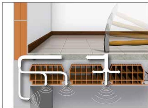
Propagação do ruído através da estrutura de um edifício realizado com betonilha monocamada
