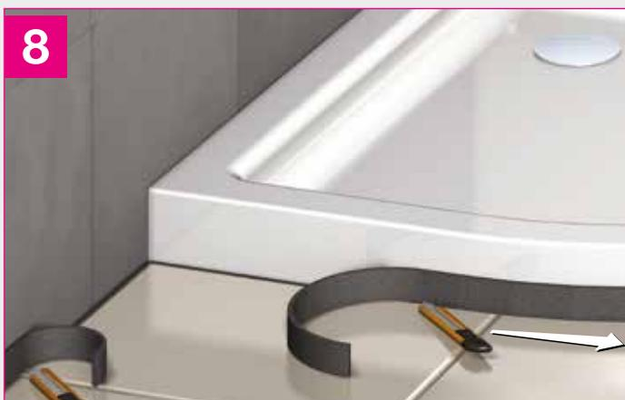
Cortar SILENS GP 1 só depois de ter aplicado os pavimentos de modo a evitar que o revestimento fique ligado com qualquer elemento na vertical.
